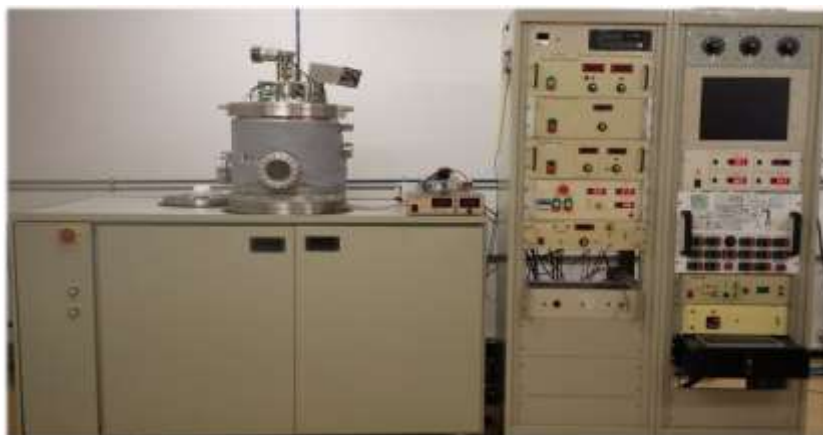
Figura 1. Equipamento de ion plating e sistema de controle do LESTT
