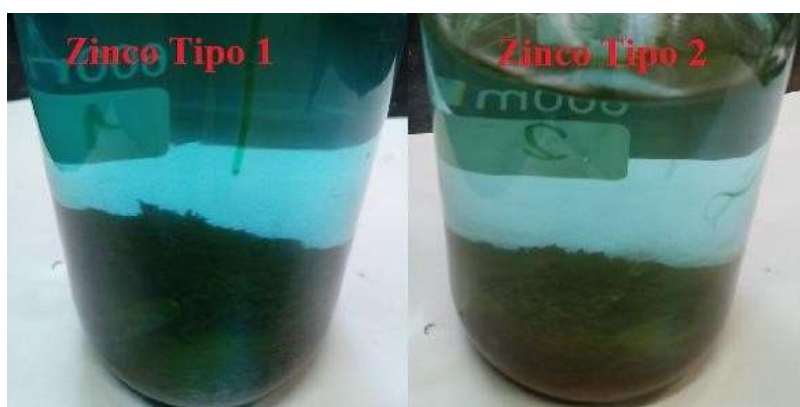
Figura 9. Reação dos resíduos de zinco tipo 1 e 2 com solução a 10% de sulfato de cobre.
