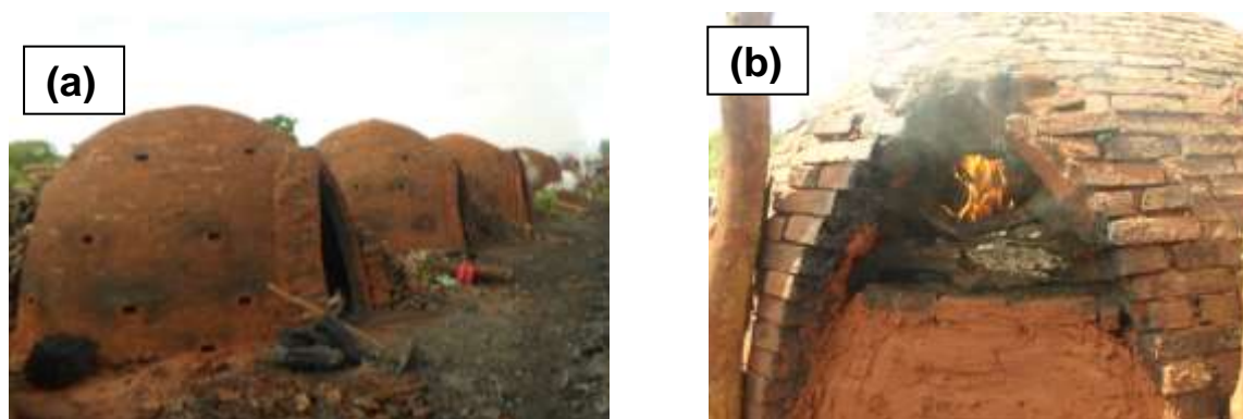
Figura 2 – Imagem dos fornos estudados: (a) mostra o forno com as linhas da baiana e tatu, e (b) apresenta a região de início da chama para a carbonização.
