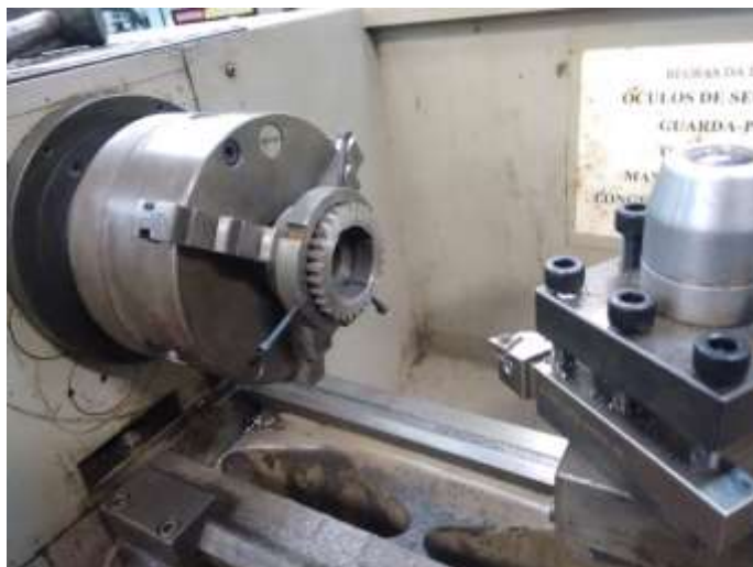
Figura 4 - Amostra e o Dispositivo de Fixação anexados ao Torno.
