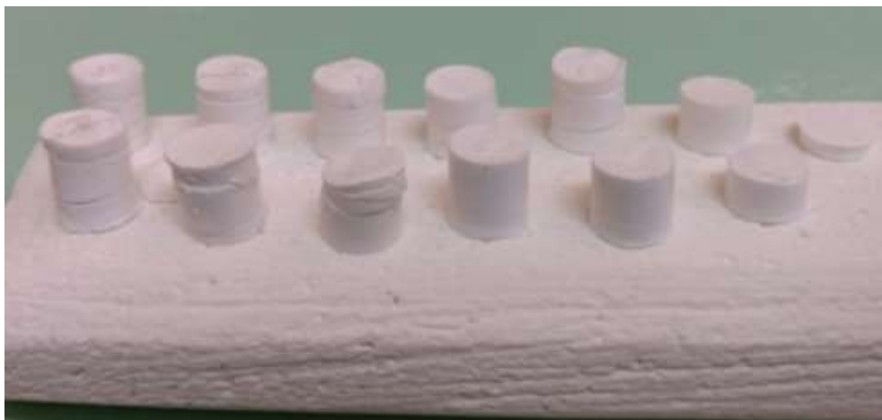
Figura 3: Corpos de prova da SILROZ HD após a sinterização.
