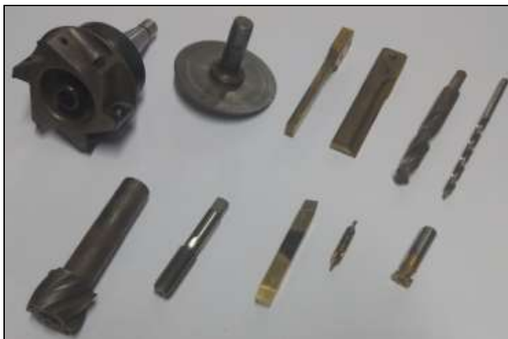
Figura 1. Seleção de ferramentas de corte e usinagem compostas de aço rápido, são apresentadas brocas: fresas, pastilhas, facas e serra circular.
