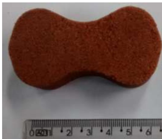
Figura 3. Corpo de prova para ensaio de tração.
