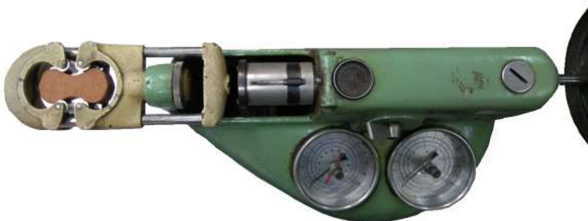
Figura 4. Equipamento Universal de ensaios com acessório para realização de ensaio de tração.
