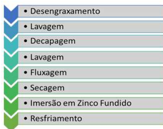
Figura 2. Fluxograma do processo de galvanização.
