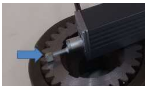
Figura 5 - Direção de Movimento da Agulha durante o Teste de Rugosidade Superficial.
