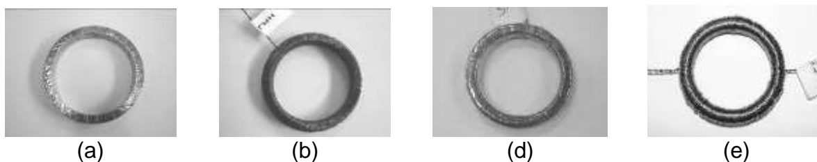
Figura 6 – Etapas de preparação das amostras: (a) isolamento, (b) enrolamento secundário, (c) isolamento e (d) enrolamento do primário
