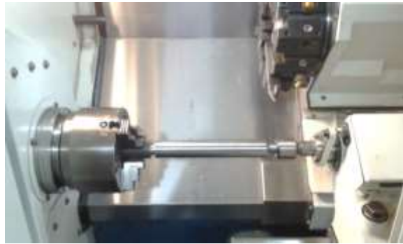
Figura 2b. Usinagem do Corpo de Prova.
