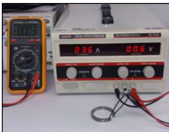
Figura 5 – Anel segmentado conectado a fonte de tensão e milivoltímetro.
