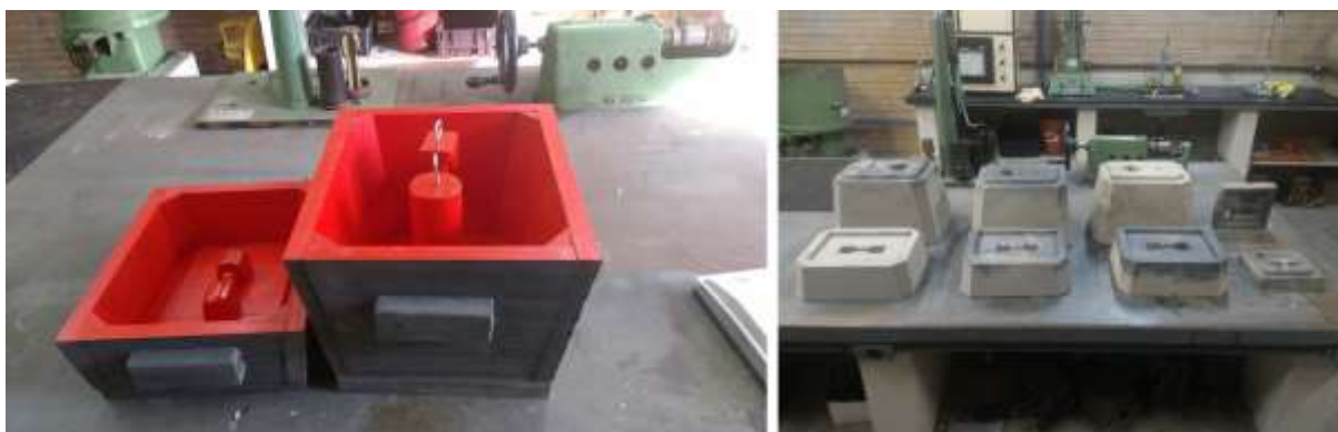
Figura 7 Ferramental em madeira para obtenção dos moldes e moldes em areia cura frio prontos para vazamento
