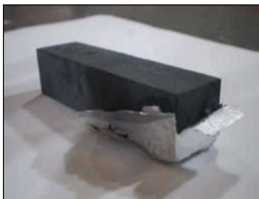
Figura 2. Remoção da camada de Zamac 5 dos CP após a austêmpera.
