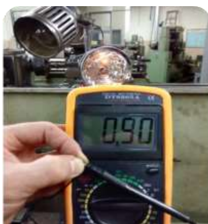
Figura 5 - Mostra os 0,90 Ampere gerados pelo dínamo na rotação de 3000 RPM
