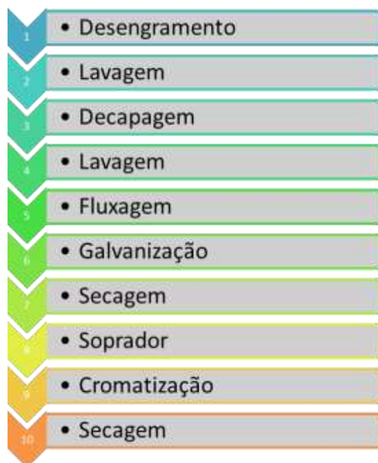
Figura 3. Fluxograma do processo de galvanização da indústria visitada.
