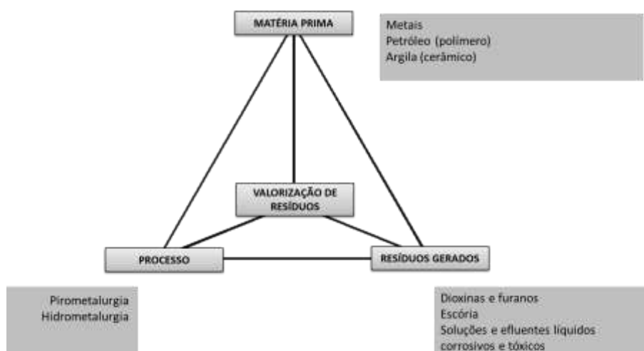
Figura 5. Tetraedro dos materiais adaptado para valorização dos resíduos eletroeletrônicos Fonte: Os autores, 2017.
