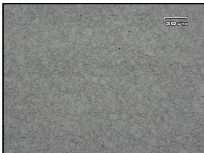
Figura 8. Micrografia mostrando a microestrutura do tubo, matriz ferrítica e agregados de perlita.
