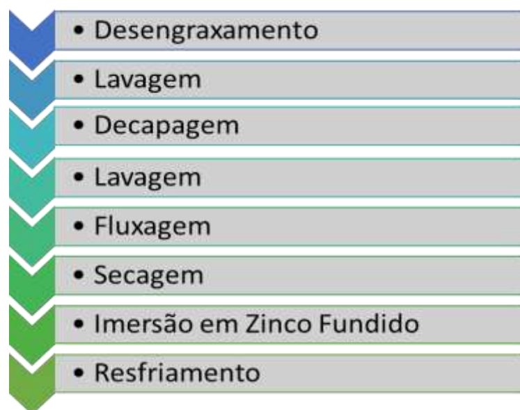
Figura 2. Fluxograma do processo de galvanização.
