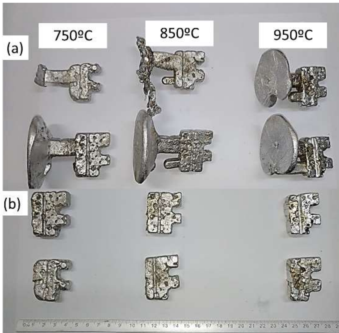
Figura 7. (a) Resultado dos vazamentos ainda com canal de ataque (b) peças após o canal de ataque ter sido retirado
