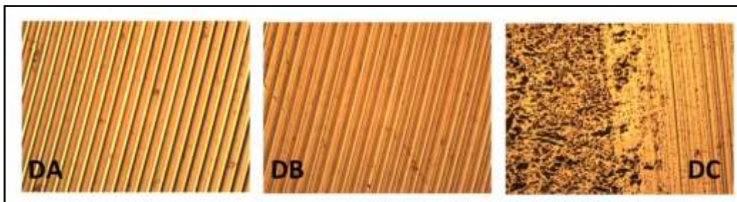
Figura 5. Riscos superficiais provenientes do processo de fabricação (DA e DB) e indícios de desgaste corrosivo (DC), ampliados 40X
