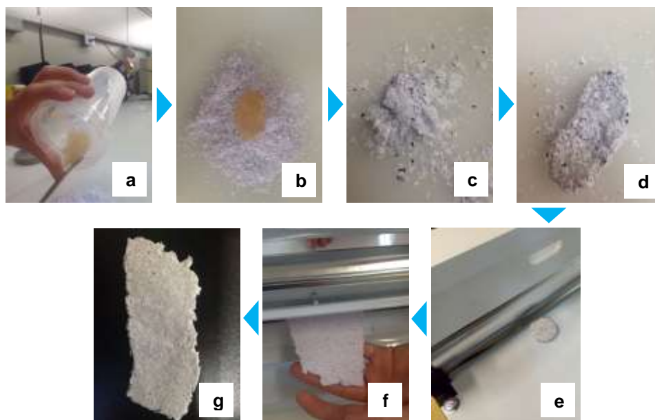
Figura 7. Etapas de processamento para obtenção do material amido/papel: amido gelatinizado (a); inserção do amido gelatinizado sobre um pouco de papel (b); mistura ao amido seco (c); mistura final dos dois tipos de amido com papel (d); entrada do material no laminador (e); saída do material do laminador (f) e aparência final do material após extração da água (g).
