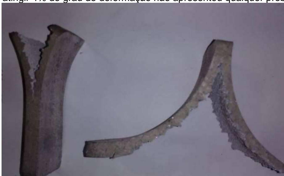
Figura 4 – Defeito alligatoring ocorrido nas amostras.
