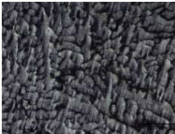
Figura 5- Microestrutura dendrítica da amostra bruta de fusão da liga MRI 230D (aumento de 50x).
