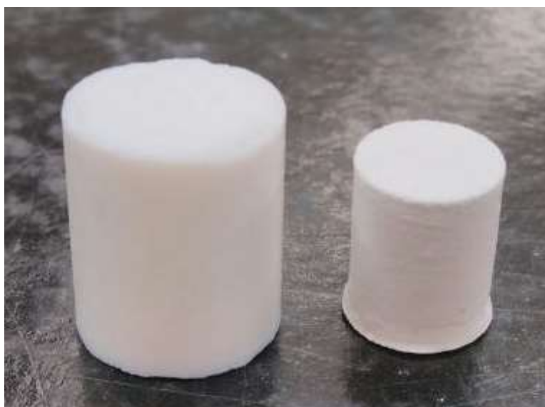
Figura 4: Corpos de prova antes e depois da sinterização.
