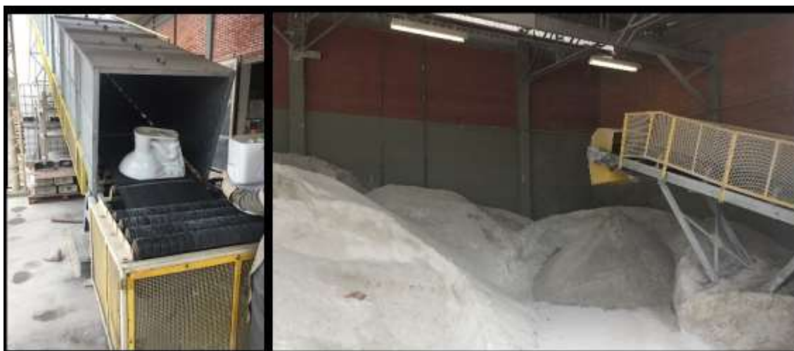
Figura 1. Peças defeituosas sendo quebradas e o depósito de pitcher em uma empresa de louças sanitárias (Fonte: Acervo pessoal).
