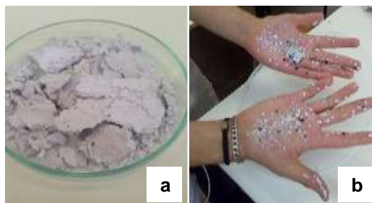
Figura 6. Resultado do processamento com máxima (a) e mínima (b) incorporação do reforço deste estudo.
