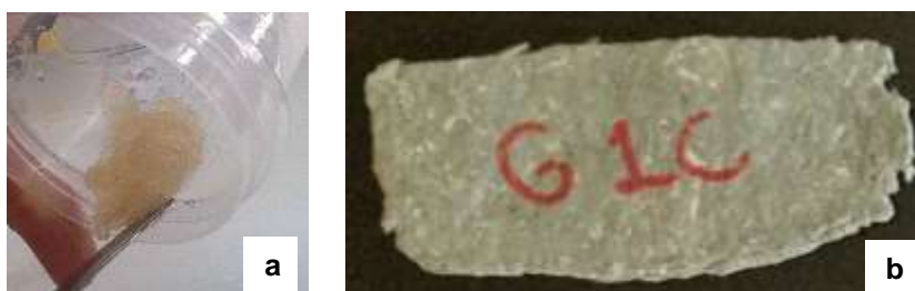
Figura 3. Amido gelatinizado com aparência homogênea processamento (a) e resultado final (b).
