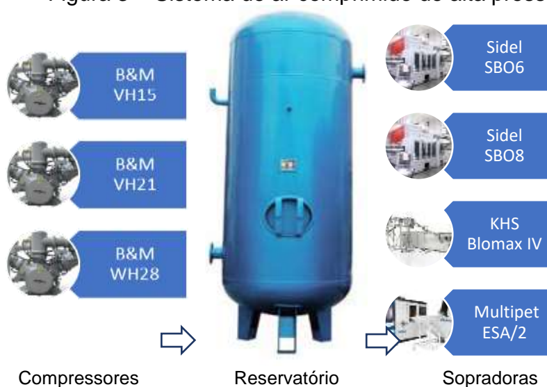
Figura 3 – Sistema de ar comprimido de alta pressão.
