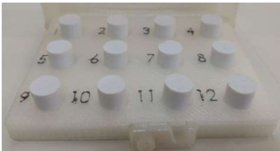
Figura 2: Corpos de prova da SILROZ HD após a compactação.
