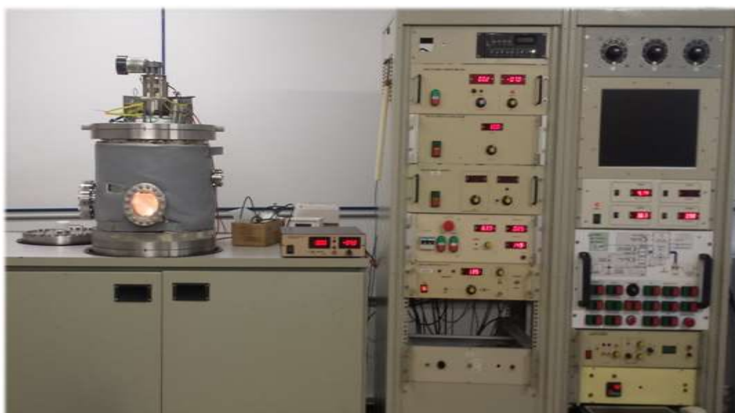
Figura 1. Câmara e sistema de controle do ion plating da UCS
