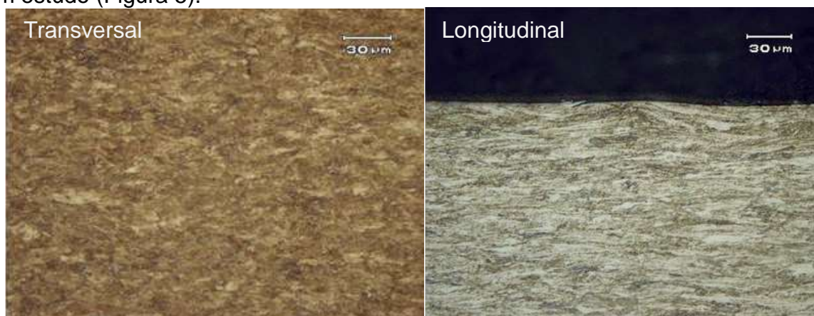
Figura 5 - Metalografia de secção transversal e longitudinal de um arame de armadura de tração.
