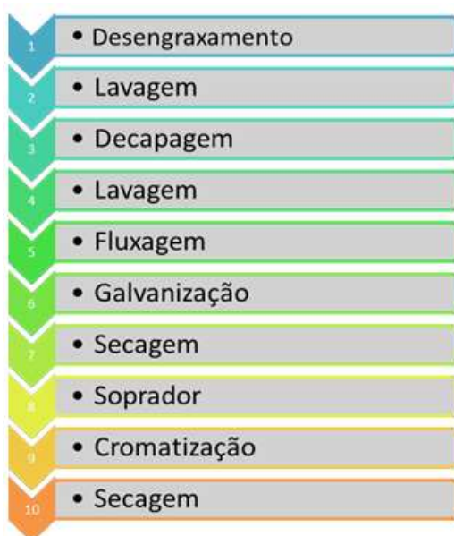
Figura 3. Fluxograma do processo de galvanização da indústria visitada.
