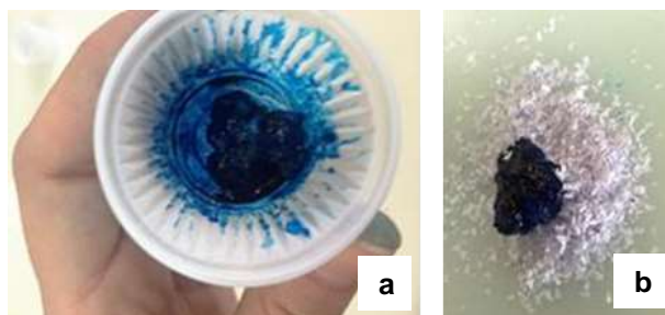
Figura 12. Incorporação do pigmento ao amido gelatinizado (a) com posterior adição de papel (b).
