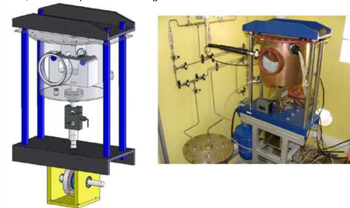
Figura 4 - Sistema desenvolvido para controle do meio corrosivo nos ensaios de corrosão-fadiga.
