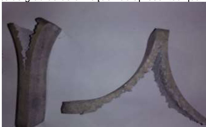
Figura 1 – Defeito alligatoring ocorrido nas amostras.
