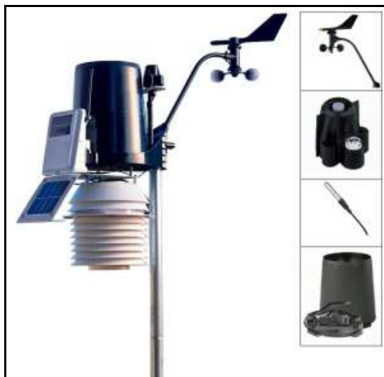
Figura 8 – Componentes de uma estação meteorológica automática [8]
