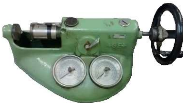
Figura 3. Equipamento Universal de ensaios para realização de ensaio de compressão.
