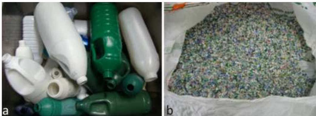
Figura 2 - Embalagens de PEAD de produtos de limpeza pós consumo após a limpeza (a) e na forma de flakes após a moagem (b).
