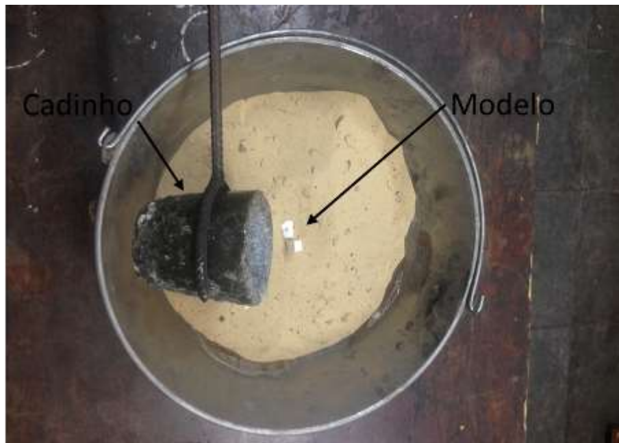
Figura 6: Aparato utilizado para o vazamento.
