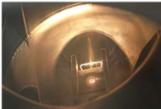
Figura 4. Incidência do canhão de elétrons no material a ser implantado
