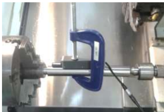
Figura 4b. Medição da rugosidade superficial.
