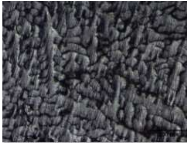
Figura 2- Microestrutura dendrítica da amostra bruta de fusão da liga MRI 230D (aumento de 50x).
