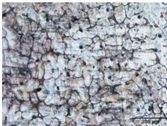
Figura 6 - Metalografia da liga MRI230D após redução de altura de 7% feita por laminação a quente (aumento de 50x)
