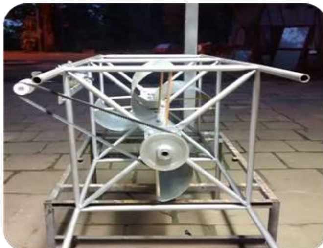
Figura 2 - Acoplamento entre o dínamo gerador ao eixo da turbina através de uma correia.
