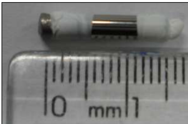
Figura 4 Amostra preparada para processo de eletropolimento.
