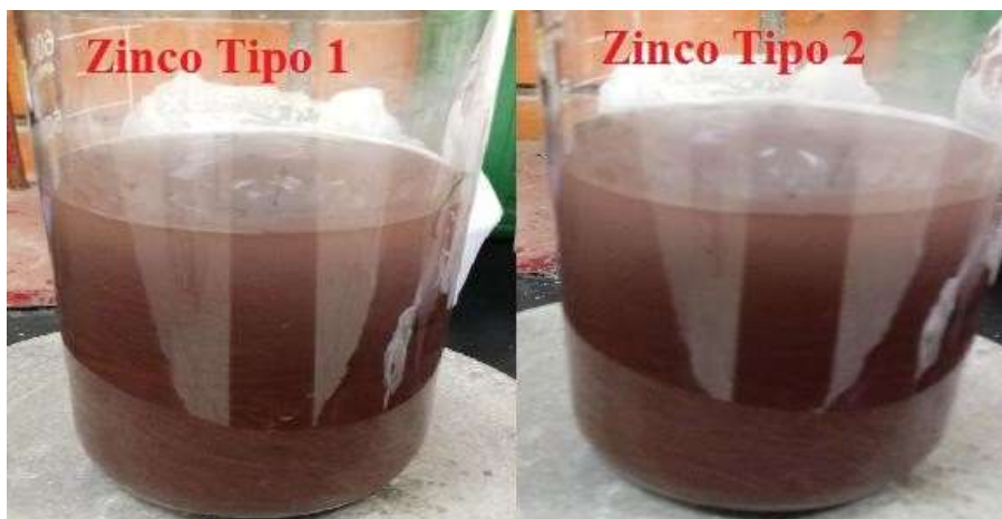
Figura 10. Cobre depositado com resíduo de zinco após ataque com ácido sulfúrico.
