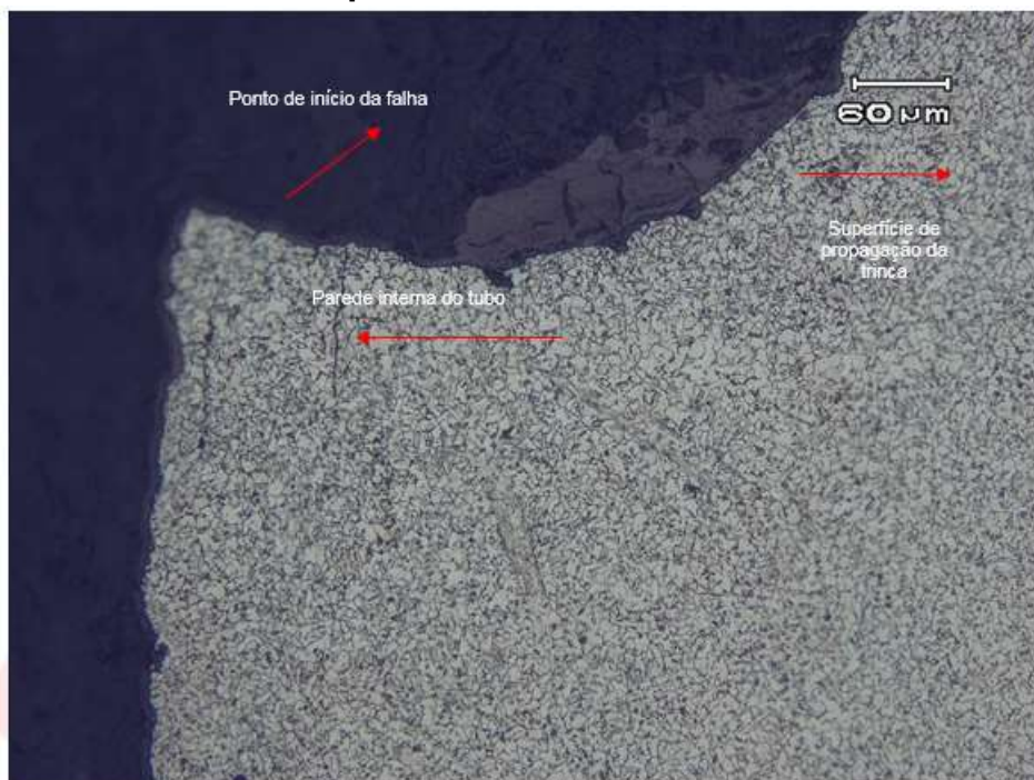
Figura 7. Micrografia mostrando ponto de início da falha.
