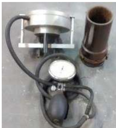
Figura 4. Equipamento para realização de ensaio de tração.
