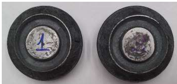
Figura 3. Amostras identificadas como 1 e 2 para o estudo comparativo após forjamento e resfriamento, cada uma com um diâmetro de 80mm e altura de 28.8mm .
