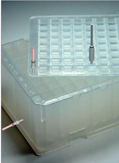
Fig. 5 - Inicialmente o componente inferior é balanceado automaticamente através dos bocais dos canais quentes num molde para dois componentes, enquanto os tempos de preenchimento para ambos os componentes são controlados no interior da cavidade usando sensores de temperatura da parede do molde
