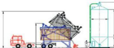
Para carregamento e descarregamento de granéis secos em pó ou pellets movimentados em contêineres padrão 20' conforme ISO 668:1995, com liner interno.
