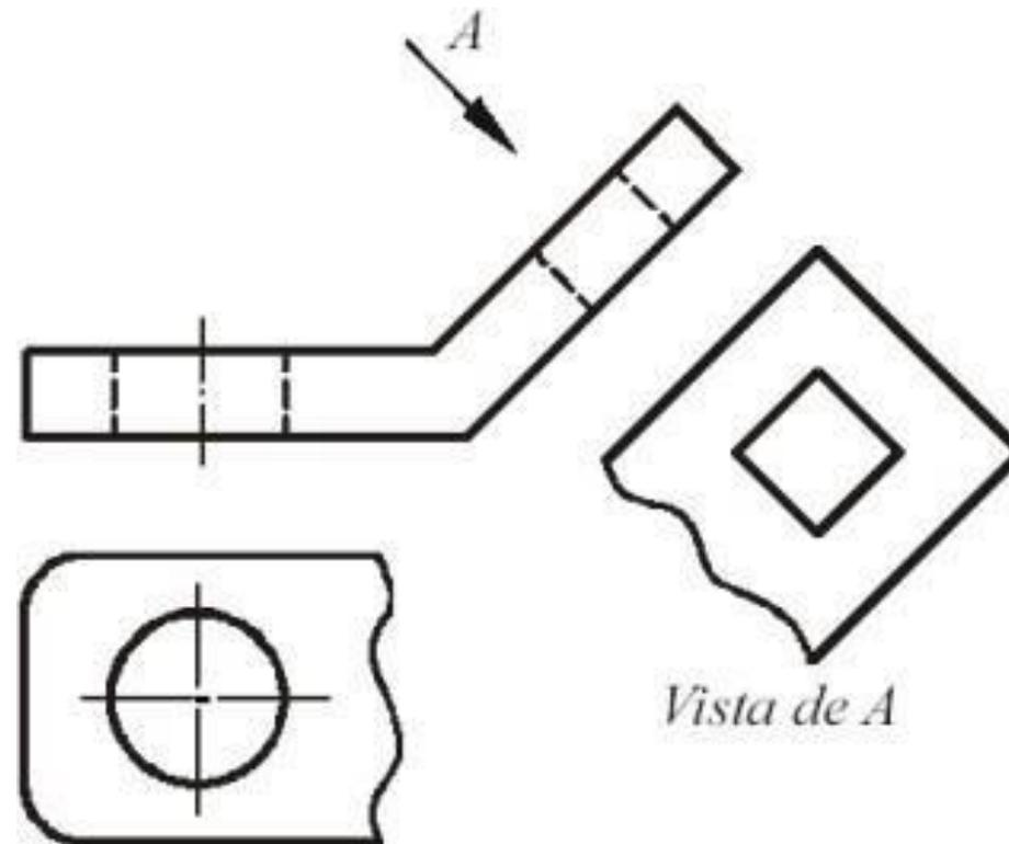
As vistas auxiliares, como são localizadas em posições diferentes das posições resultantes das vistas principais, devem ter o sentido de observação indicado por uma seta designada por uma letra, que será usada para identificar a vista resultante daquela direção. A figura mostra que as vistas auxiliares, além de representarem a forma do objeto com maior clareza, permitem que as cotas sejam referenciadas em verdadeiras grandezas nas dimensões cotadas.
