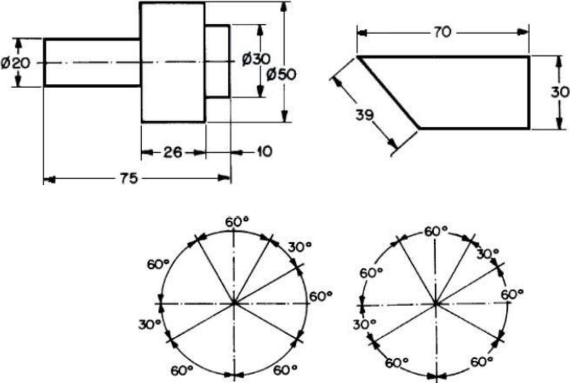
Cotagem em série: O próprio nome já diz, utiliza-se um vértice como referência, geralmente no canto inferior esquerdo, para iniciar a cotagem e as novas cotas são inseridas a partir das cotas já existentes.
