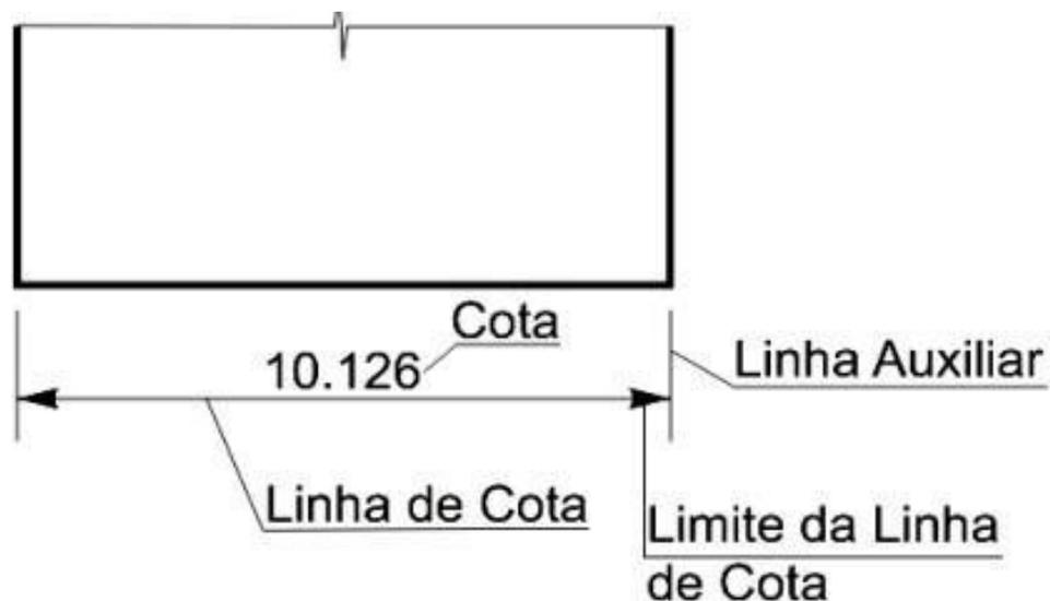
As linhas auxiliares e de cotas devem ser desenhadas como linhas estreitas contínuas. A linha auxiliar deve ser prolongada ligeiramente além da respectiva linha de cota. Um pequeno espaço deve ser deixado entre a linha de contorno e a linha auxiliar.
