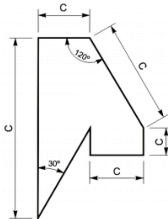
A linha auxiliar deve ser perpendicular ao elemento dimensionado, mas se necessário poderá ser desenhada obliquamente a este (aprox.  $60^\circ$ ), porém paralelas entre si.
