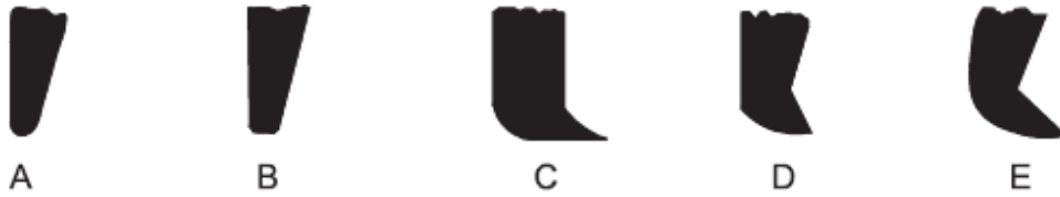
Figura 74 Perfis de faca mais utilizados no processo de espalmagem de pastas de PVC
