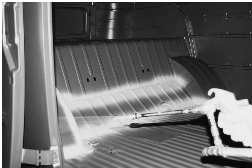
Figura 83 Aplicação, por filete, de massa para vedação de juntas da carroceria
