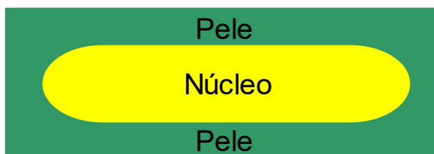
Fig.3: Seção reta da estrutura do tipo sanduíche apresentada na moldagem por co-injeção
