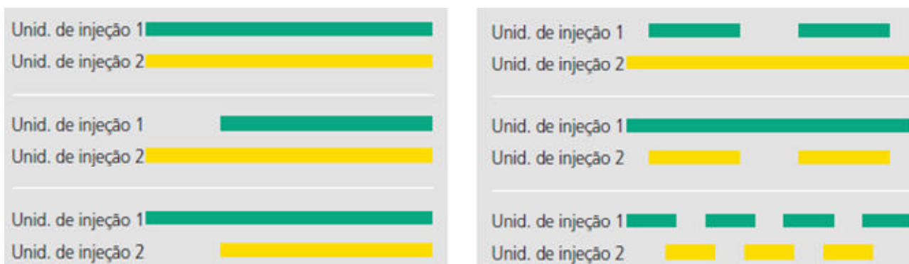
Fig. 5: A programação da válvula propicia a entrada dos materiais de uma forma simultânea ou seqüencial
