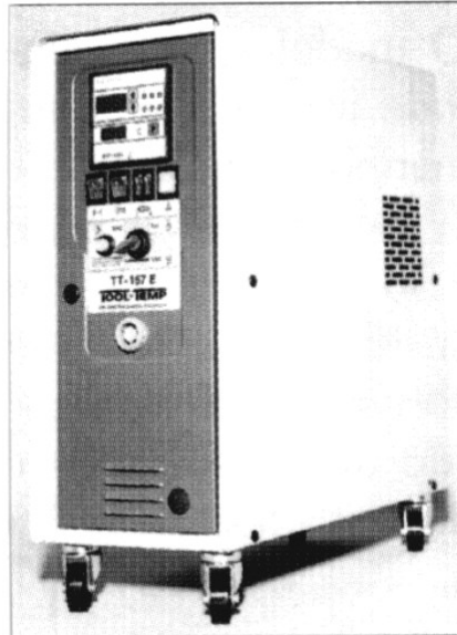
Figura 22 – Unidade móvel de água gelada central, usada para controle de temperatura de apenas um equipamento.
