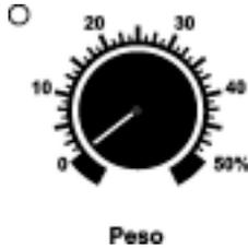
Determina a abertura mínima da ferramenta durante a programação. Possui uma faixa de ajuste de 0 a 50% da abertura total da ferramenta. No modo extrusão contínua o ajuste de PESO fica permanentemente habilitado, como pode ser comprovado pelo led indicador do ajuste de Peso, ativo.
