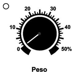
Determina a abertura mínima da ferramenta durante a programação. Possui uma faixa de ajuste de 0 a 50% da abertura total da ferramenta. No modo acumulação o ajuste de PESO é habilitado somente durante a extrusão (chute), como pode ser comprovado pelo led indicador do ajuste de Peso, ativo.
