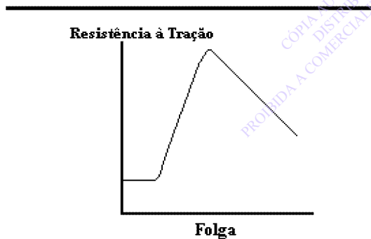
Figura 17.21 - Resistência à Tração da Junta obtida por Brasagem, em Função da Folga.
