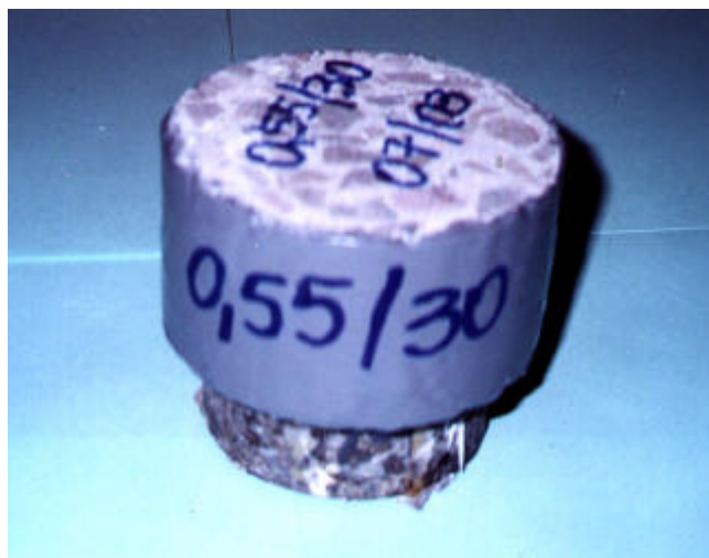
Figura 6.10: aspecto das laterais do corpo-de-prova seladas com resina epóxi
