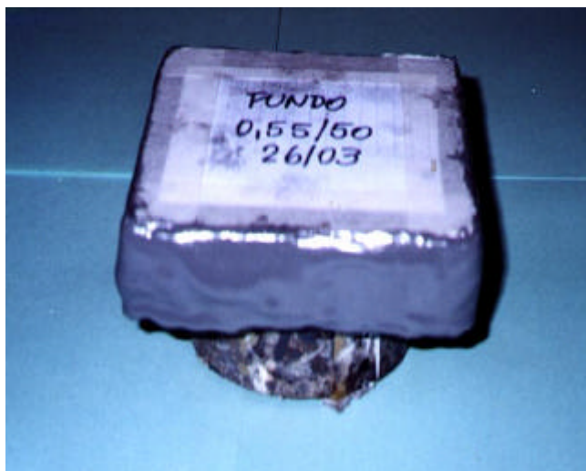
Figura 6.7: aspecto das laterais do corpo-de-prova de absorção seladas com resina epóxi
