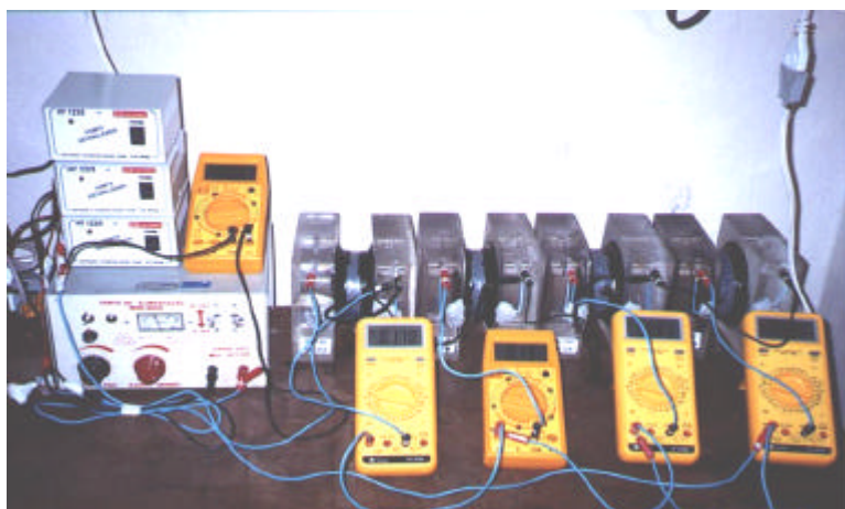
Figura 6.12: ensaio de penetração de íons cloretos
