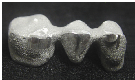
Superfície rugosa gerada por excesso de temperatura do anel de fundição.
