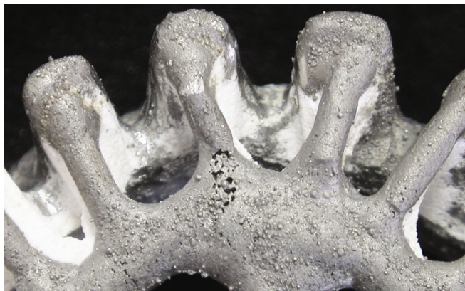
Porosidade causada por gases do processo de fundição.
