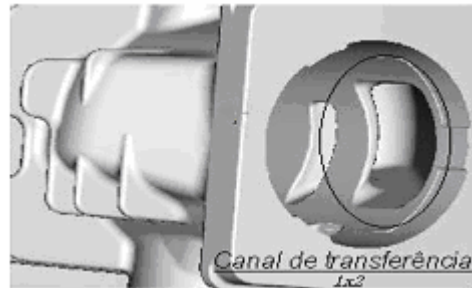
Figura 4 - Vista interna dos canais de transferência do cilindro.
