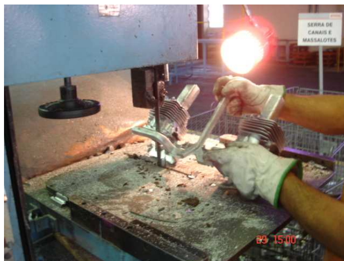
Figura 15 vista do corte de canais e massalotes
