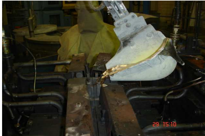
Figura 12 vista da concha enchendo a coquilha com alumínio líquido
