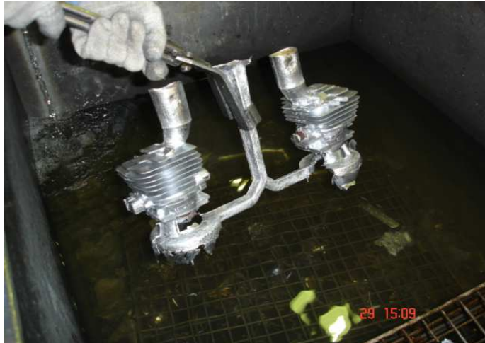
Figura 14 vista do tratamento de estrutura solubilização
