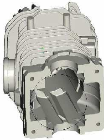
Figura 2 – Vista interna dos canais de transferência do cilindro.
