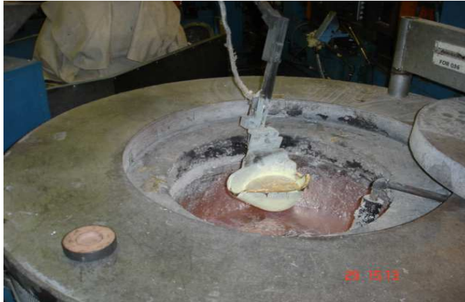
Figura 10 vista forno de trabalho da célula coquilhadeira
