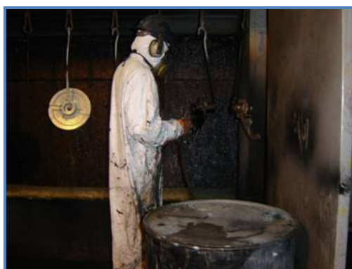
FIGURA 10 – Setor de pintura, com cabine com cortina d'água.
