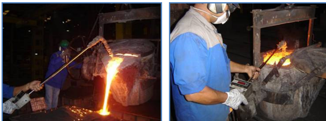
Figura 7 – Vazamento de metal líquido no molde de areia (a) e verificação da temperatura do metal (b).
