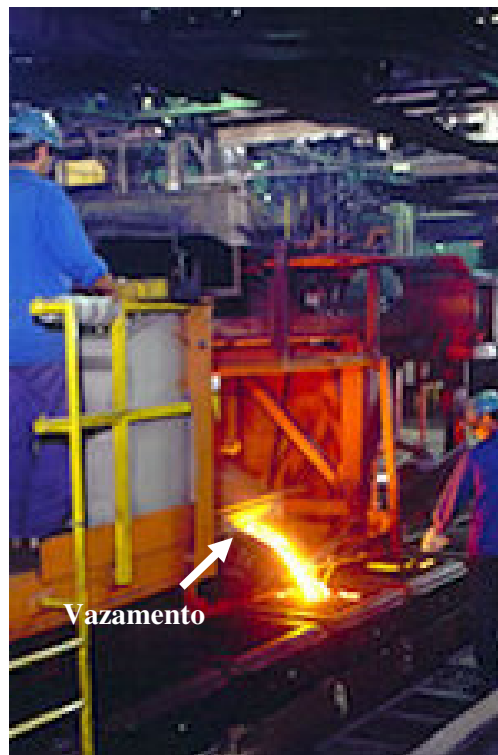
Figura 5. O vazamento do metal no molde.
