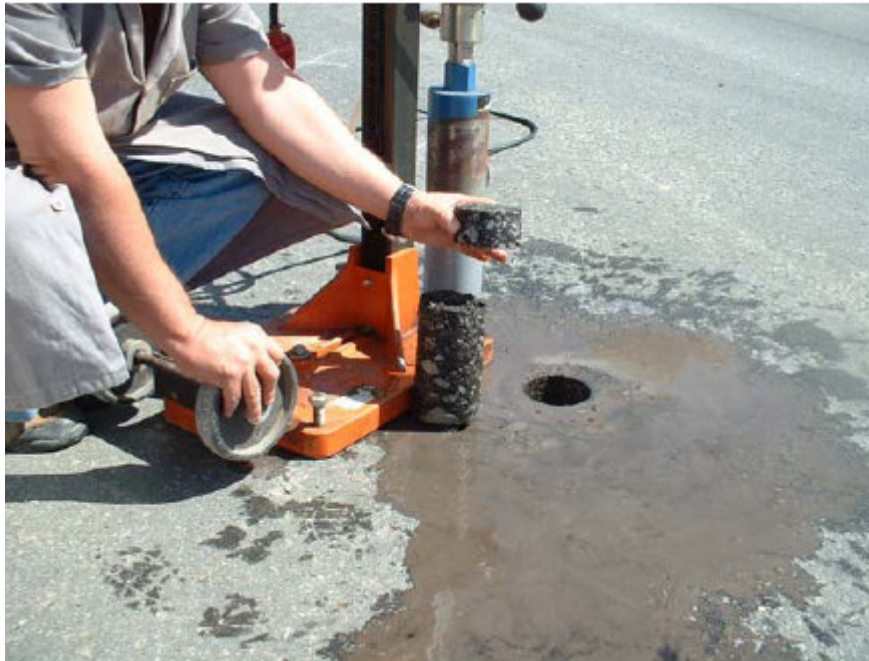
Figura 19. Sonda rotativa para extração dos corpos-de-prova do trecho experimental em Extrema-MG.
