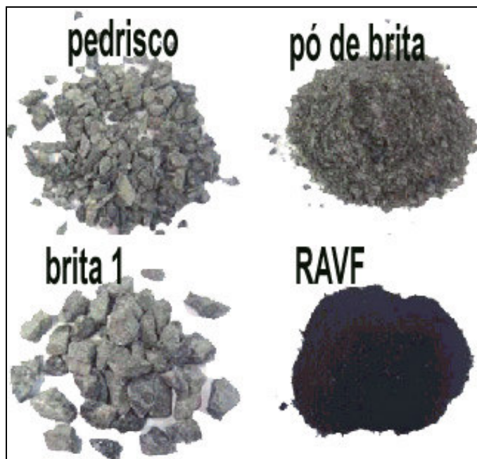
Figura 15. Materiais utilizados na elaboração do CAUQ preparado em laboratório.
