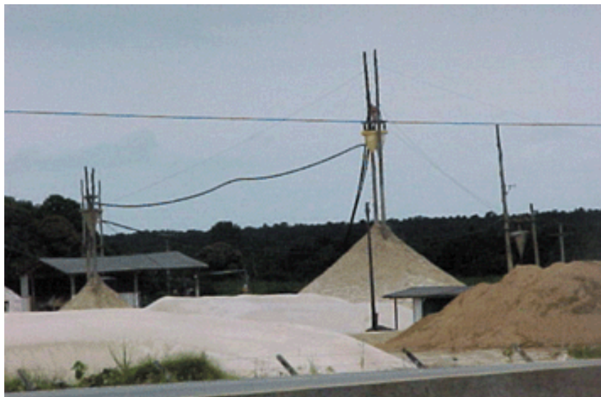
Figura 1. Instalações de beneficiamento da areia utilizada no processo de fundição (FERREIRA, et al , 2003).
