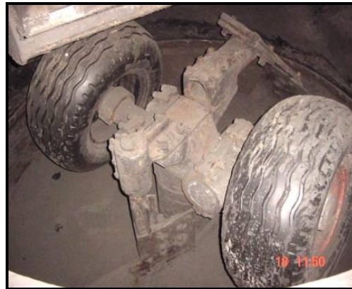
Figura 9. O misturador das matérias-primas constituintes da AVF (PEREIRA, 2005).
