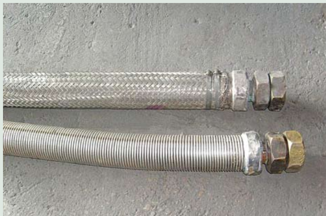
Flexível novo, com revestimento sobre o tubo corrugado, e , abaixo, flexível antigo, sem o revestimento sobre o tubo
