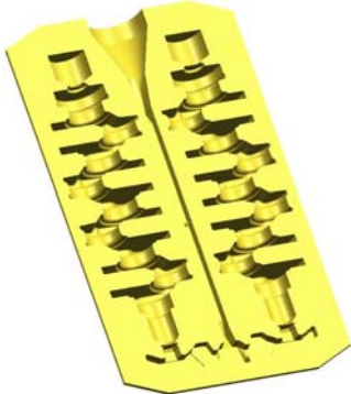
Figura 1 – Metade de um molde shell .
