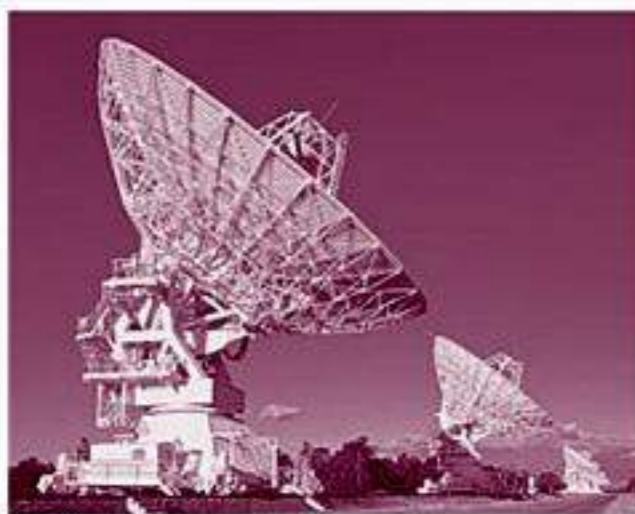
Sinais incidentes são refletidos pela antena parabólica para o receptor no foco.
