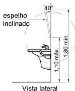
Colocação de espelho em sanitário para PNE
